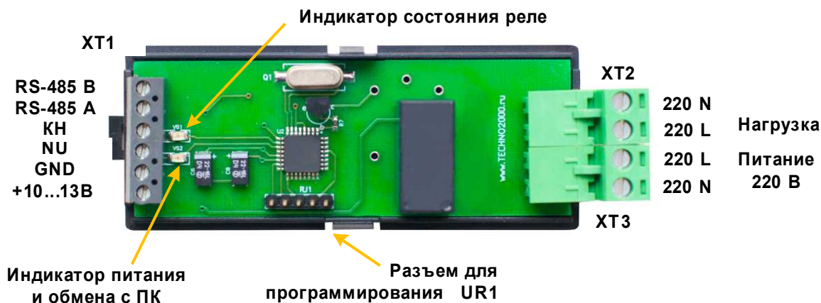
Рис.2 Назначение выходов модуля входов-выходов DV-APR1D
