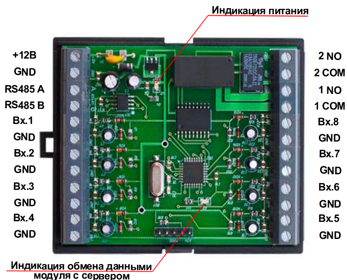
Рис.3 Назначение выходов модуля DV8-ОПС
